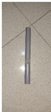
Gambar 15 Pipa Kondisi Bocor Besar
