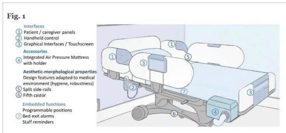
**Gambar 1. 2 Gambar model tempat tidur mekanik**
