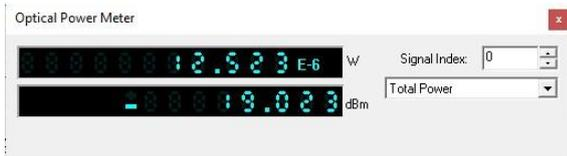
Gambar di atas merupakan hasil pengukuran dari OPM untuk jarak terjauh pada FAT-033, dari gambar tersebut didapatkan bahwa nilai daya terima yaitu -19.023 dBm, hasil tersebut sudah memenuhi standar PT. Indonesia Comnets Plus (ICON+) dan ITU-T bahwasannya nilai daya terima tidak boleh lebih dari -25 dBm. Maka dari itu bisa di simpulkan bahwa hasil tersebut dapat di katakan layak.
