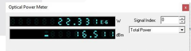
Gambar di atas merupakan hasil pengukuran dari OPM untuk jarak terdekat pada FAT-001, dari gambar tersebut didapatkan hasil bahwa nilai daya terima yaitu -16.511 dBm, hasil tersebut sudah memenuhi standar PT. Indonesia Comnets Plus (ICON+) dan ITU-T bahwasannya nilai daya terima tidak boleh lebih dari -25 dBm. Maka dari itu bisa di simpulkan bahwa hasil tersebut dapat di katakan layak.
