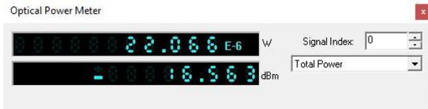
Gambar di atas merupakan hasil pengukuran dari OPM untuk jarak terdekat pada FAT-001, dari gambar tersebut didapatkan hasil bahwa nilai daya terima yaitu -16.563 dBm, hasil tersebut sudah memenuhi standar PT. Indonesia Comnets Plus (ICON+) dan ITU-T bahwasannya nilai daya terima tidak boleh lebih dari -25 dBm. Maka dari itu bisa di simpulkan bahwa hasil tersebut dapat di katakan layak.
