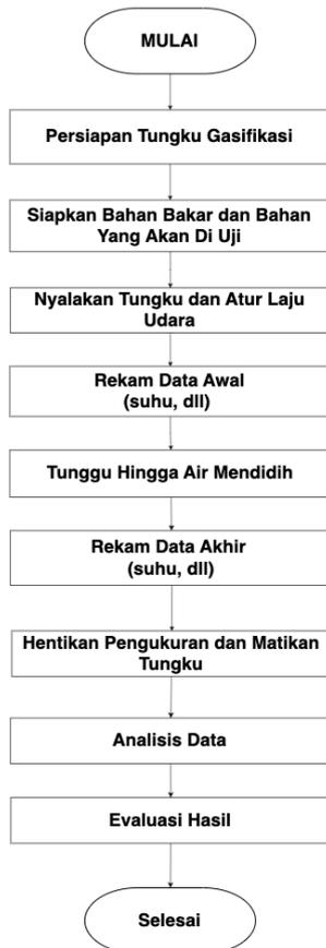
**Gambar 3.2 Flowchart Pengujian**
