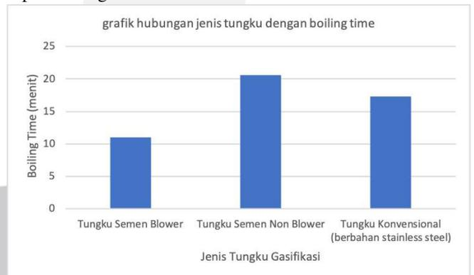
Gambar 4.4 Grafik Hubungan Jenis Tungku Dengan Boiling Time
