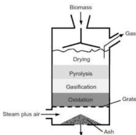
**Gambar 2.1 Skema Tungku Gasifikasi *Updraft***
