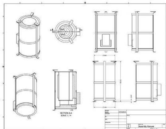
**Gambar 3.1 Assembly Tungku Gasifikasi *Updraft***
