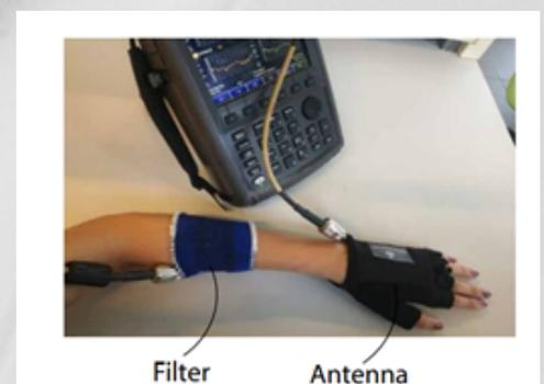
Gambar 2 Fabrikasi filter and antenna dengan menggunakan bahan yg flexible oleh J. Hanna
