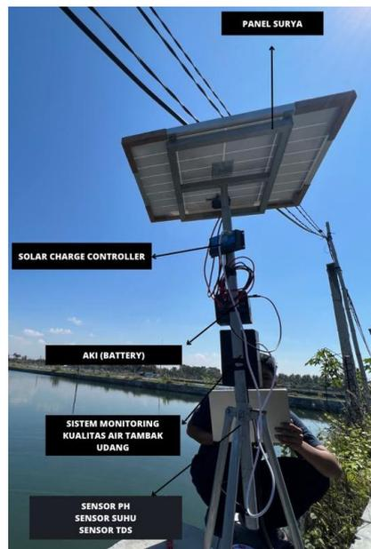
**Gambar 1.** Alat Keseluruhan Sistem Monitoring
