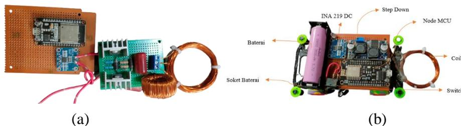
Gambar 6. Gambar (a) ini Merupakan Rancangan Hardware *Transmitter* dan Gambar (b) adalah Hardware *Receiver*.
