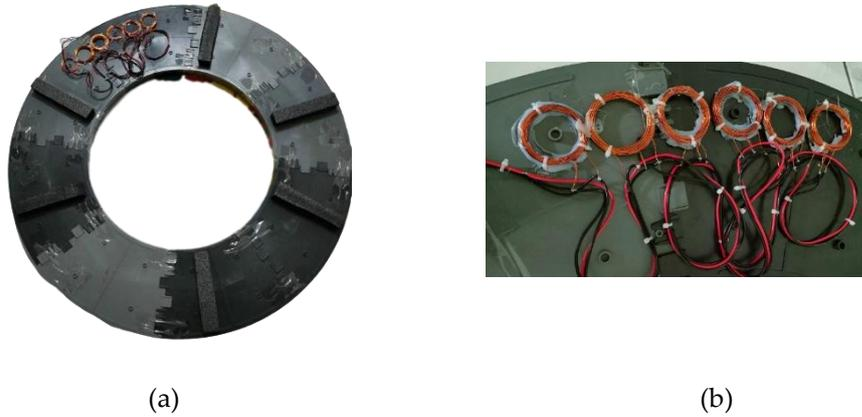
**Gambar 7.** Gambar (a) adalah Circuit EV dengan Coil Transmitter dan Gambar (b) adalah Coil Transmitter yang Tersusun Pararel
