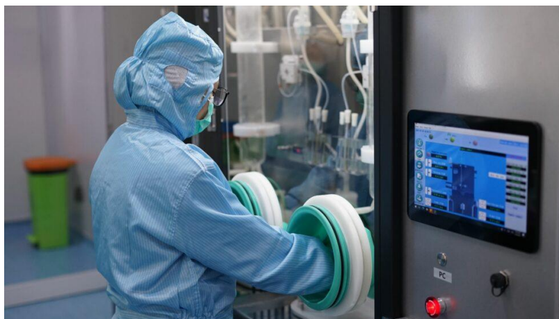
Gambar I.1 PT XYZ Surabaya melakukan analisis Bacterial Filtration Efficiency (BFE) masker medis dengan menggunakan BFE tester
