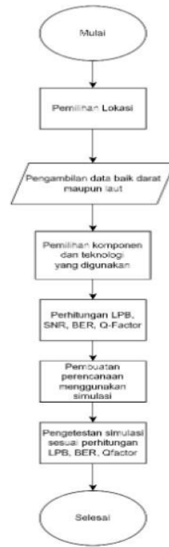
GAMBAR 1. Flowchart Alur Perancangan Jaringan Sistem Komunikasi Kabel Laut
