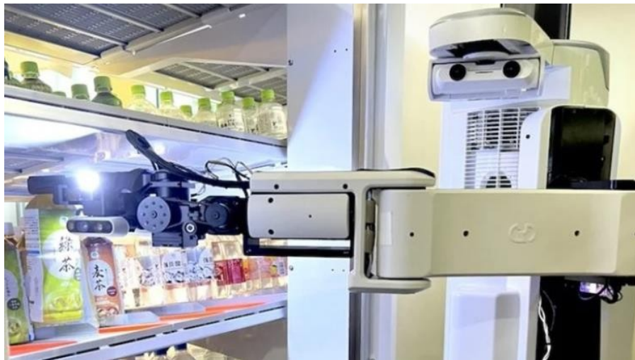
Gambar 1.8 Robot Pengisi Rak Penyimpanan FamilyMart Bertenaga AI
