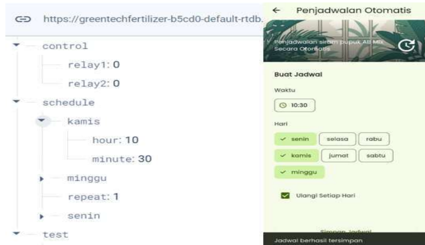
Gambar 4. 8 pengujian aplikasi penjadwalan dengan realtime database
