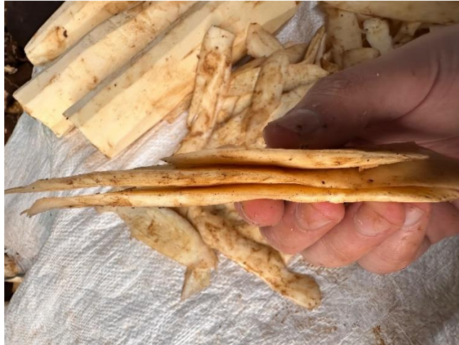
Gambar I.5 Tebal Hasil Pengupasan Pisau Aktual
