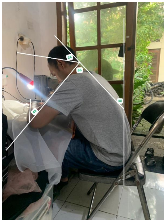
Gambar 1. 4 Perhitungan Sudut Operator Bagian Kiri
