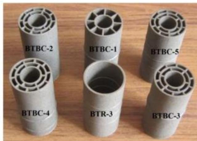
Gambar 1. 6 Struktur Bionic Bamboo 2
