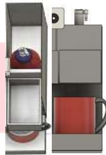
GAMBAR 2.II-2 Contoh 3D tampak atas dan depan dispenser air
