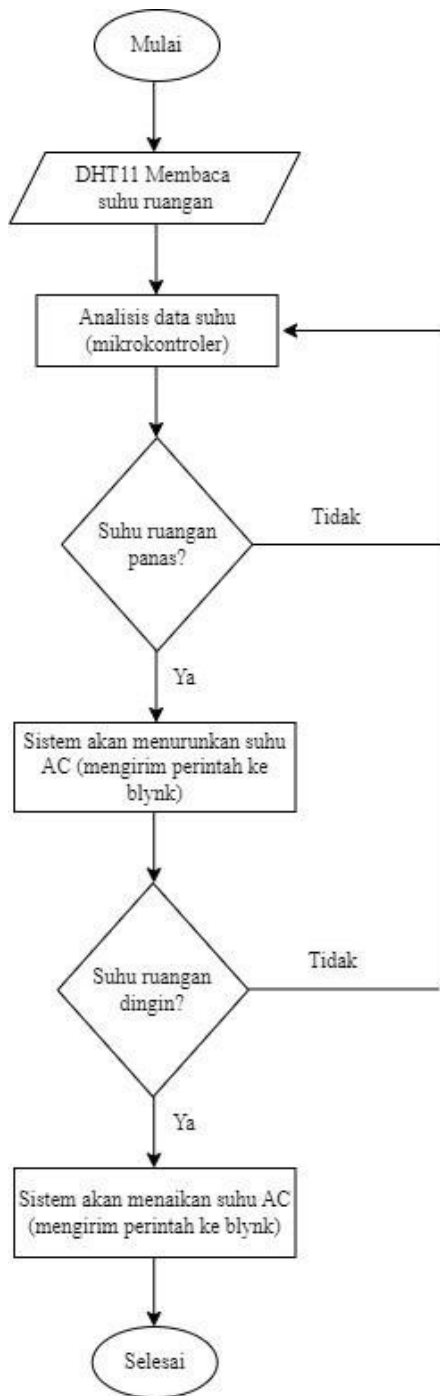
GAMBAR 10 FLOWCHART SISTEM PENGATUR SUHU RUANGAN
