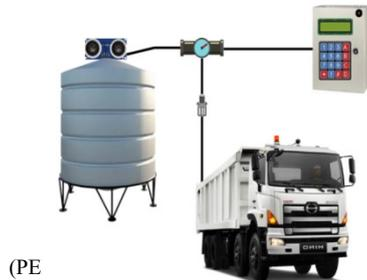
Proyek ini mensimulasikan sistem pencatatan bahan bakar menggunakan prototipe tangki 10 liter dengan tinggi 30 cm, dibandingkan dengan tangki asli di lokasi kerja yang berkapasitas 10.000 liter. Dengan skema serupa, prototipe ini dirancang untuk penerapan di masa depan mengingat keterbatasan akses ke lokasi. Perbandingan skala antara prototipe dan sistem asli adalah 1:1000.
