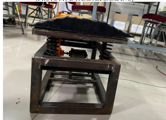
GAMBAR 8 (POSISI PEGAS PADA PROTOTIPE SPEED BUMP.)
