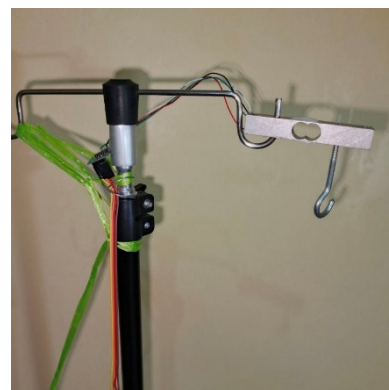
GAMBAR 11 (Sensor Load Cell pada Tiang Infus)
