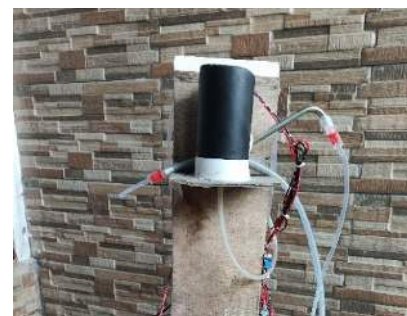
GAMBAR 14 (Mengintegrasikan pompa galon elektrik dengan kontainer pupuk AB)
