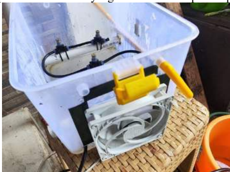
GAMBAR 17 (Tampilan area misting dengan kipas dan sensor DHT22)
