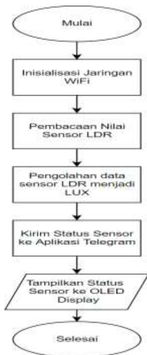
Gambar 3 Diagram Alur Program Perangkat Keras
