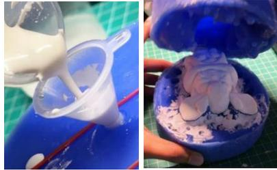
Gambar 1 Ceramix kedalam cetakan
