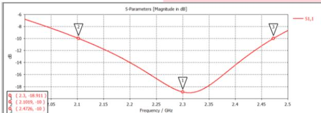
Gambar 9 (Hasil return loss dan bandwidth rancangan antenna)
