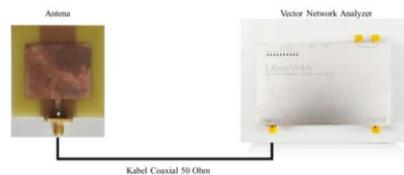
Gambar 7 (Ilustrasi Pengukuran return loss Antena)
