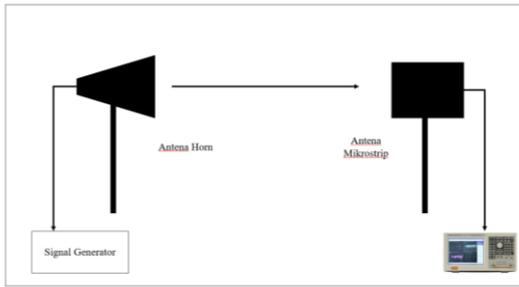
Gambar 8 (Ilustrasi Pengukuran gain dan pola radiasi Antena)
