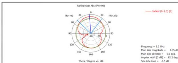
Gambar 11 (Hasil pola radiasi rancangan antenna)
