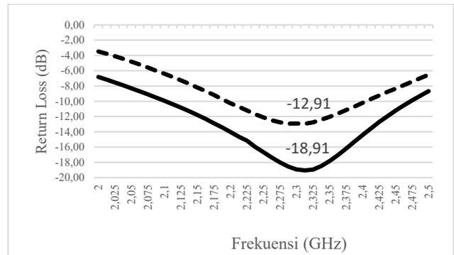
Gambar 13 (perbandingan return loss simulasi dan pengukuran)
