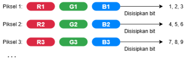
Gambar 5 Mekanisme Penyisipan Bit ke Kanal
