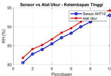
Figure 8 Grafik Sensor Vs Alat Ukur Kelembapan Tinggi
