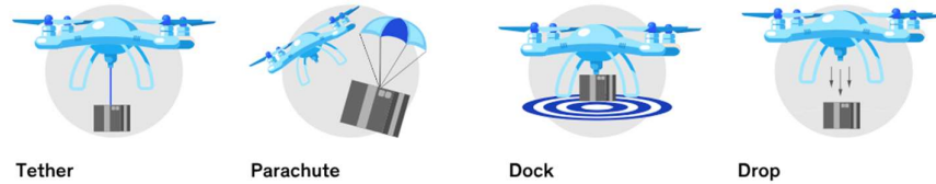
Gambar I-1 Empat teknik pengiriman barang menggunakan drone yang digunakan amazon (McKinsey & Company, 2023).
