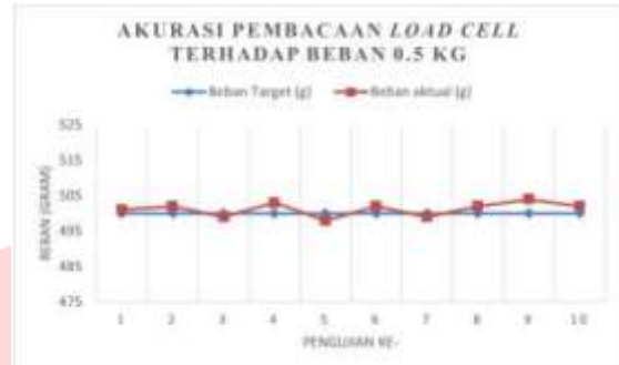
Gambar 14 Grafik Akurasi Pembacaan Load Cell Beban 0.5 kg.
