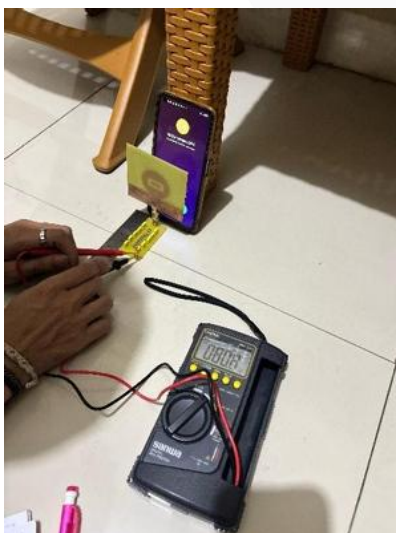
GAMBAR 14 (Pengujian Rectenna dengan handphone )
