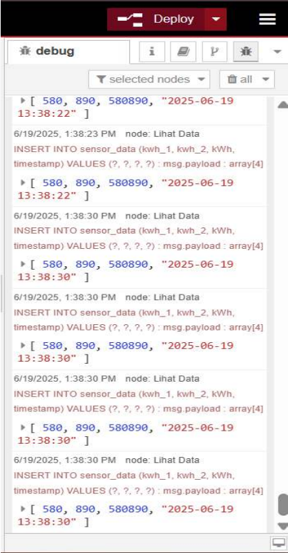
Gambar 4. 2 Debug /keluaran dari flow Node-RED
