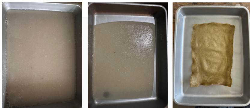
Gambar 5 Hasil Pengeringan Biomaterial Berbasis Bubuk jelly kilon
