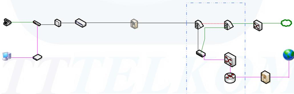
Gambar 1.1. Posisi DSLAM MA-5300 dan BRAS MA-5200 di dalam ruangan MDF ( Box biru )
