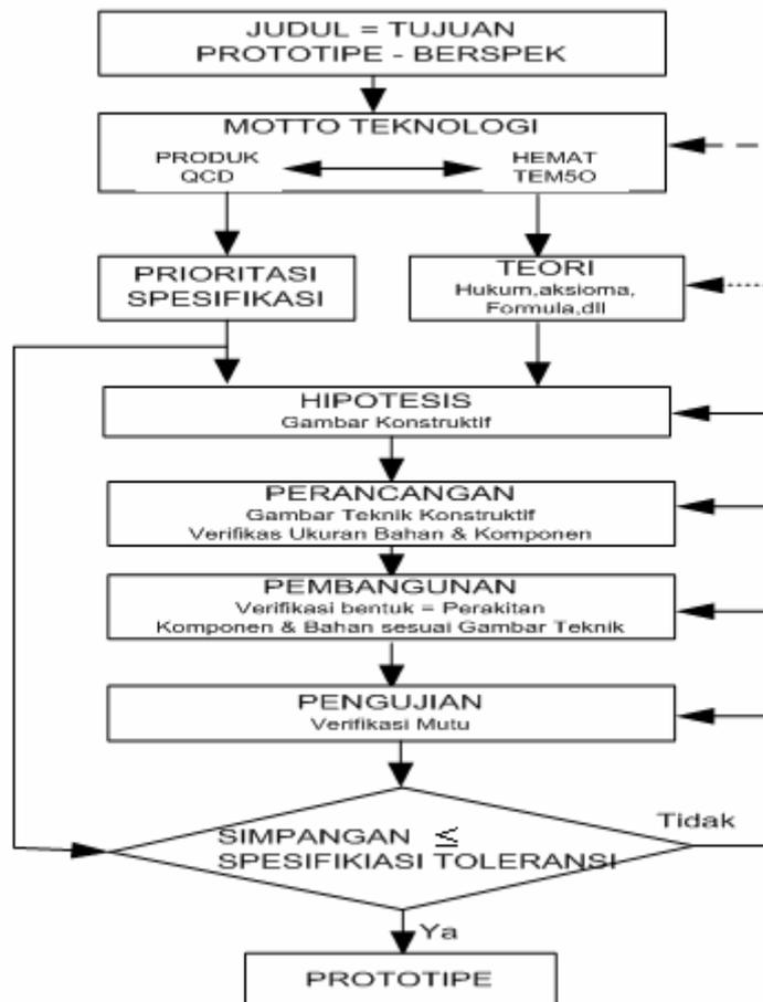
Gambar 1.1 Diagram Alir Rancang Bangun Suatu Prototipe <sup>[11]</sup>
