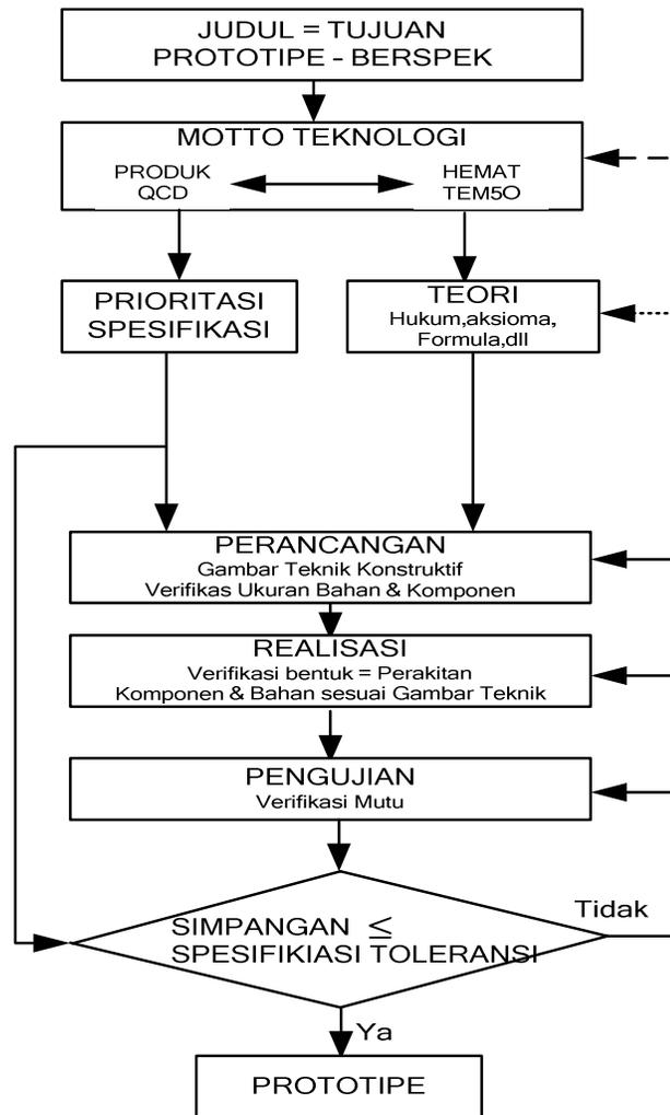
Gambar 1.1 Diagram Alir Perancangan dan Pembuatan Antena Tricula klopfenstein Unidireksional
