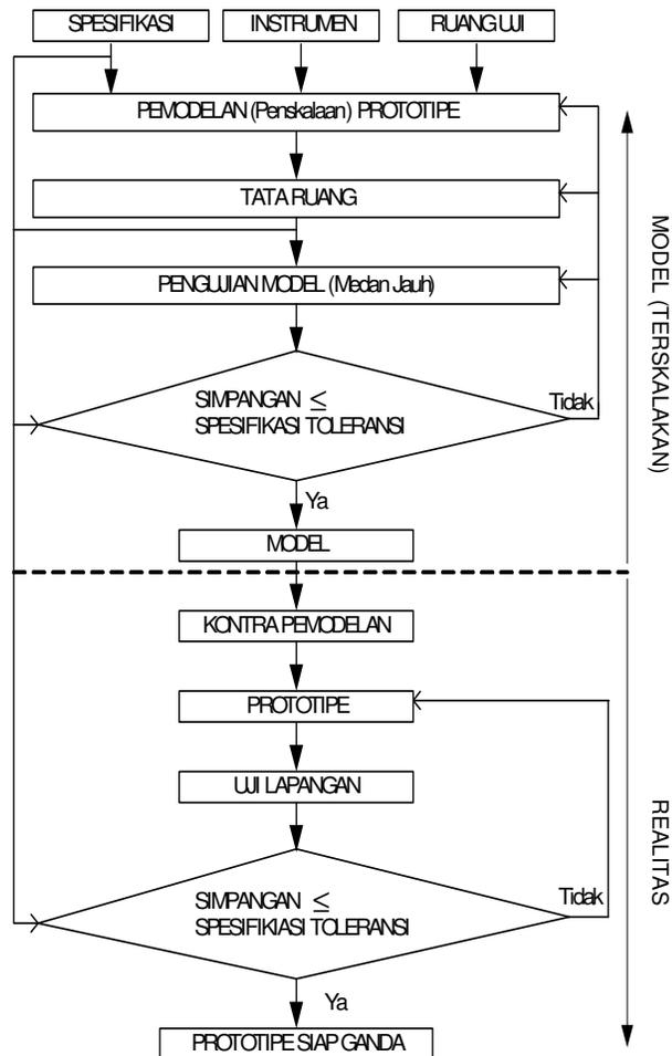
Gambar 1.2 Diagram Alir Pengujian Prototipe Antena
